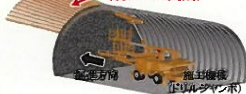
補助工法の対策事例
